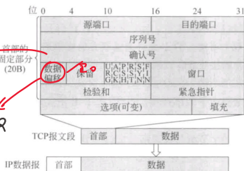
图 8-6 TCP 报文段的格式
